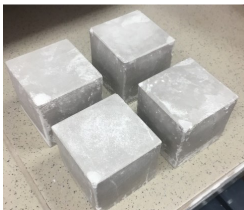
Рис. 2. Образцы бетона для испытания
